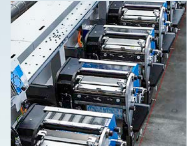
Recorrido de banda especialmente corto reduce el desperdicio.
