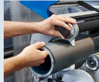
La carga frontal para las camisas anilox permite un cambio rápido y sencillo.
