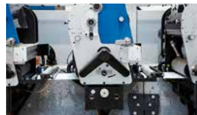
El corto recorrido de banda de tan solo 1,1 m reduce el desperdicio de papel y aumenta la rentabilidad al máximo.
