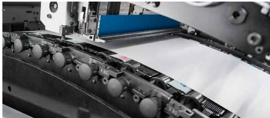
Inter Color Pinning garantiza alta calidad de impresión y variedad de soportes.
