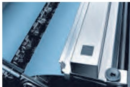
Los revestimientos del cilindro Transfer Jacket Blue y Perfect Jacket Blue aseguran la ausencia de marcas en el pliego y una calidad de impresión óptima.
