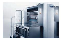
Salida de pila normal compacta que necesita poco espacio diseñada especialmente para tiradas pequeñas y medianas.
