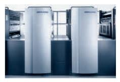
Trabajo confortable con cuerpos de impresión accesibles y una galería lateral espaciosa.
