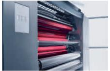
Tiempos de puesta a punto cortos y entintado estable gracias al cuerpo entintador/humectador único con amplias funciones preajustables (Preset).
