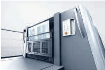
Cambio de planchas totalmente automático con AutoPlate Pro o AutoPlate XL.
